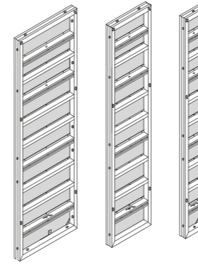
OC panely s výškou 330cm Šírka: 135cm, 90cm, 60cm, 55cm, 50cm, 45cm, 30cm, 25cm
